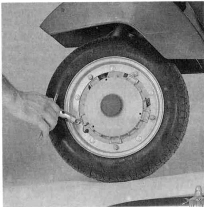
Desmontaje rueda delantera; para la trasera seguir el procedimiento análogo.
